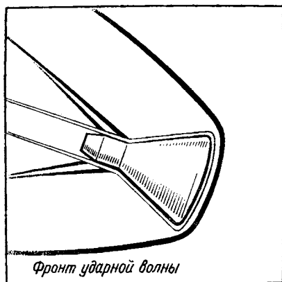
Рис. 43. Образование ударной волны при вхождении в плотные слои атмосферы.
